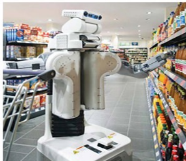
쇼핑하는 로봇 PR2. 원하는 물건의 정보를 인터넷에서 확인하고 나서 매장에서 해당 물건을 찾아 쇼핑을 한다. 사람에게 서비스를 하는 데 필요한 콘텐츠와 소프트웨어 등을 네트워크에 연결된 외부 컴퓨터에서 가져와 쓰는 '클라우드 로봇'이다.
